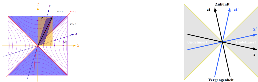
(a) Minkowski-Diagramm für zwei Koordinatensysteme (x, t) und (x', t') (b) Minkowski-Diagramm mit eingezeichnetem Lichtkegel [H]
